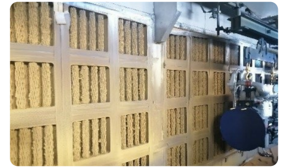
开展干式喷漆房改造项目，提升喷漆废气的吸附去除效率，降低废气排放浓度
